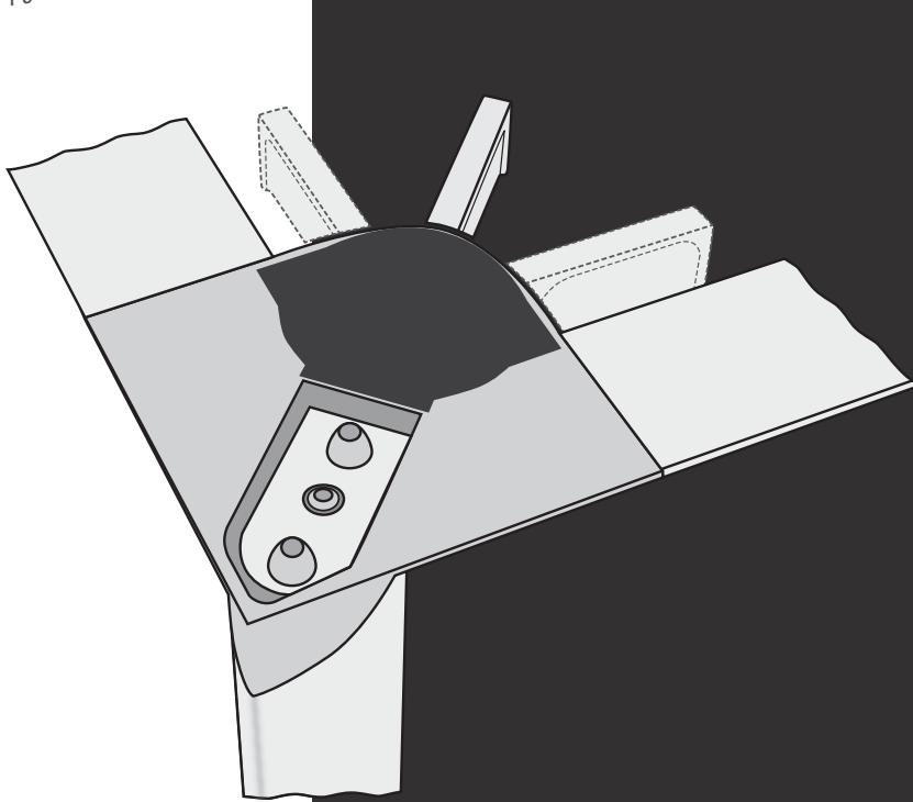
Die praktische, unter dem Tisch angebrachte Mechanik ermöglicht bei Auf- und Umbauten von kleinen wie auch großen Konferenzlösungen eine schnelle, werkzeugfreie und flexible Montage.
