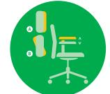
9. Multifunktionsarmlehne mit vielen Variablen für alle Sitzgewohnheiten: drehbar sowie höhen- und breitenverstellbar.
