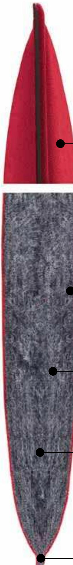
**I**\_Le superfici del pannello sono rivestite in tessuto di poliestere Trevira CS® solidamente applicato all'imbottitura interna con la quale forma un corpo unico senza soluzione di continuità. Proprietà che permette di ottenere una superficie che, pur essendo visivamente molto soft, risulta essere resistente, difficile da strappare e da perforare.
