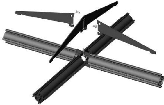
Durch die Knoten-Überspannung wird die Knoten/Stützen-Verbindung stabilisiert. Bei höherer statischer Beanspruchung kommt die Unterspannung zum Einsatz. Siehe entsprechende Kapitel hierzu.
