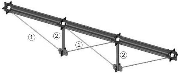
Unterspannungen werden bei einlagiger Bauweise eingesetzt, wenn Stützen mehr als eine Achse frei überspannen. Bei erhöhter Belastung mit Ergänzungssatz.
