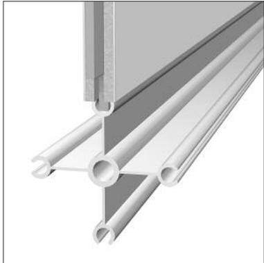
Integrierte Wandfüllungen werden mit einer 4,8mm starken Feder in die Systemnut eingesetzt. Sie sind standardmäßig für Breitenachsen bis maximal A1.200 bzw. A980 erhältlich.
