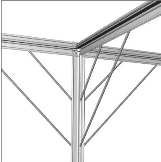
Winkelaussteifungen dienen bei frei stehenden Stützen zur Verstärkung der Diagonalsteifigkeit. Bei höheren Stützen und bei erhöhtem Gewicht des Überbaus (z.B. durch Beleuchtungselemente) sind Winkelaussteifungen nicht ausreichend. Es empfiehlt sich der Einsatz von PILA Petite III-Stützen und Diagonalverbänden.
