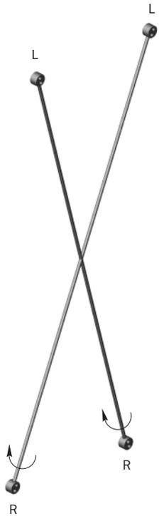
Ansatzstücke mit Standard-Rechtsgewinde sind durch eine umlaufende Nut gekennzeichnet.
