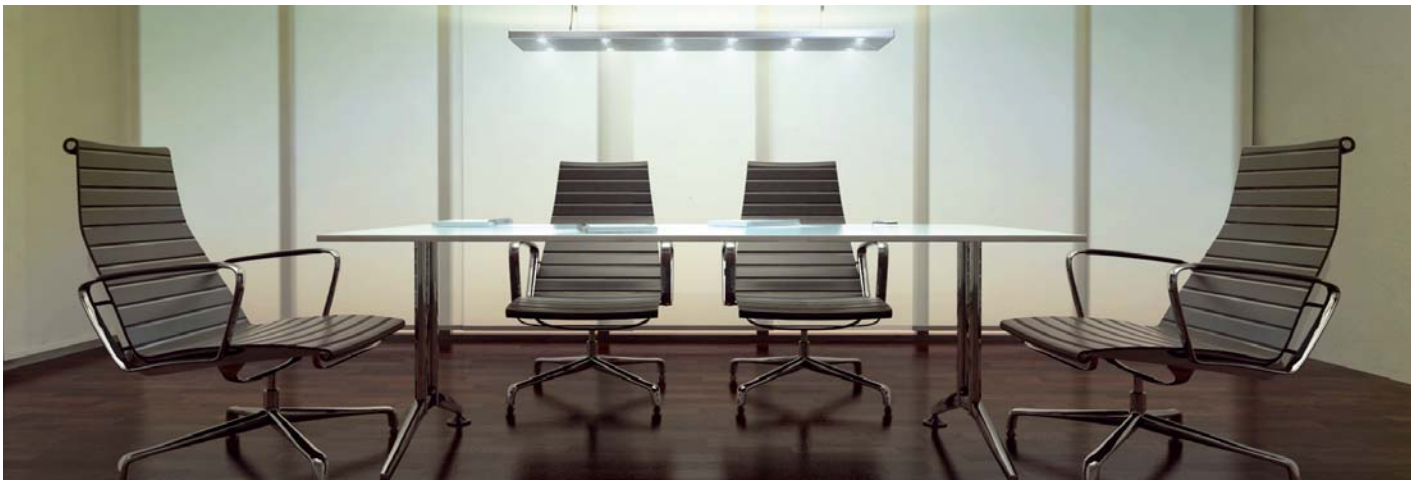
Ausgewogene Lichtstimmung mit gleichmäßiger Verteilung von LED-Direkt- und T5-Leuchtstofflampen-Indirektlicht. | Balanced lighting mood with an even distribution of direct light from LEDs and indirect light from T5 fluorescent lamps.
